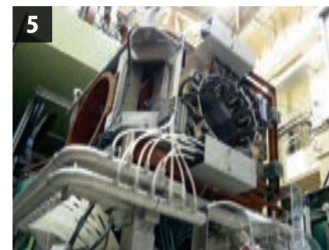
ミュオン実験装置 ミュオンビームラインの最下流に位置する装置。ビームライン に沿って導かれ、試料内部に撃ち込まれたミュオンが崩壊 する際に放出する陽電子をキャッチします。
