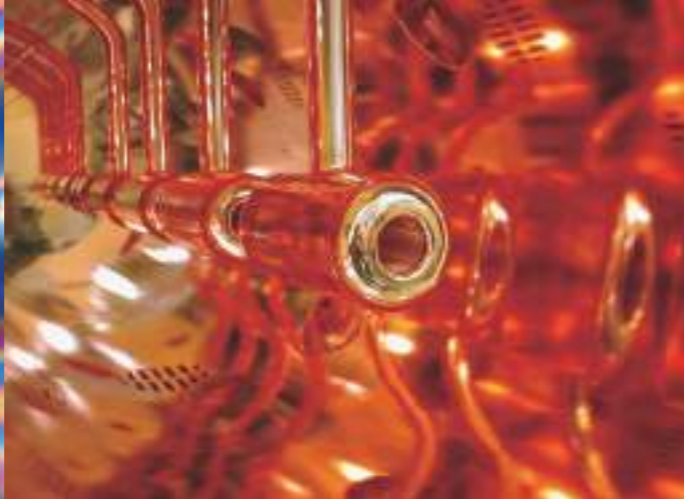
S-DTL 空洞内部
