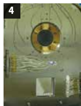
ミュオン生成標的 陽子を衝突させミュオンのもととなる \pi 中間子を発生させるための標 的。黒鉛でできた標的の周囲を 放熱のための銅で囲っています。
