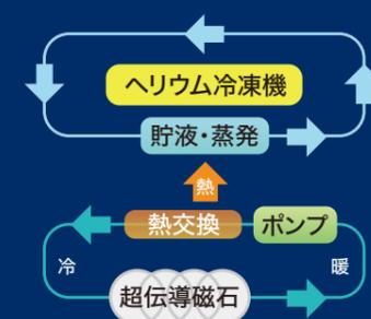
ヘリウム冷凍機で発生する寒冷によって、ニュートリノ超伝導磁石を超臨界ヘリウム経路で冷却し、供給用ヘリウムを液化している。
