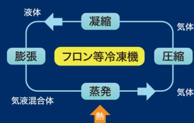
身近にあるエアコンや冷蔵庫に組み込まれている冷凍機と同様にヘリウム冷凍機も冷媒の圧縮・膨張で低温を発生する。一般の冷凍機は1つのサイクルで構成されているが、ヘリウム冷凍機はタービン膨張サイクルが加わり2つのサイクルで構成されている。また蒸発した低温ヘリウムガスと熱交換も必要になる。
