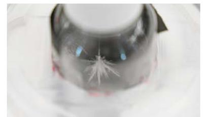
ドライアイスで冷やしたペットボトルの糸に付いた人工的な雪の結晶
