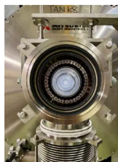
真空排気ポート越しにRF加速空洞を望む 《10兆分の1気圧の世界》
