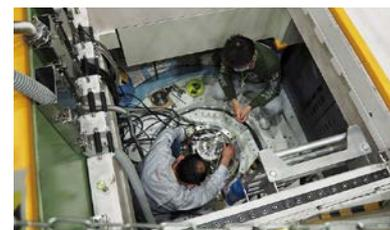
非弾性散乱実験に使用するハイエントロピー合金試料の装着の様子
