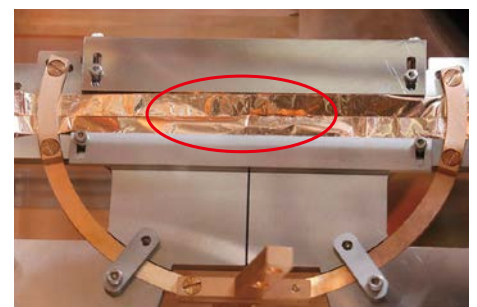
グローブボックスに取り付けられたサンプル。赤丸で示した銅の箔の中に、10個のリュウグウサンプルが入っています。
