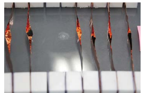
炭素質コンドライトのサンプル。リュウグウサンプルと同様の銅の箔で包まれています。
