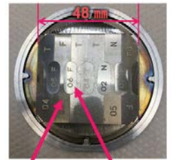
引張試験用 電子顕微鏡観察用 大強度ビーム照射用のカプセルの内部に配置された引張試験片と電子顕微鏡での観察に用いる試験片の様子。
