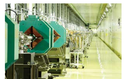
誤差 0.1mm 以内で整然と並んだリニアックの機器
