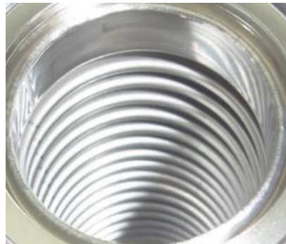
図 1. Pd/Ti コートする前の成形ベローズの内面
