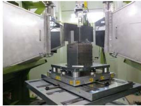
NおよびT方向応力測定時の試料セッティング(試料横置き)
