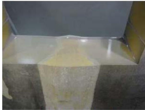
化学研磨後の試料溶接部断面写真
