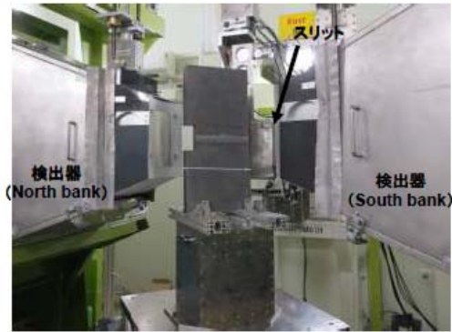
L方向応力測定時の試料セッティング(試料縦置き)
