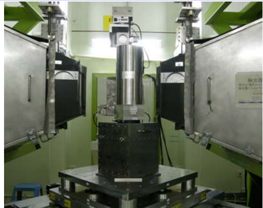
図2 中性子照射試験の光学系および測定の様子 (BL19「匠」)
