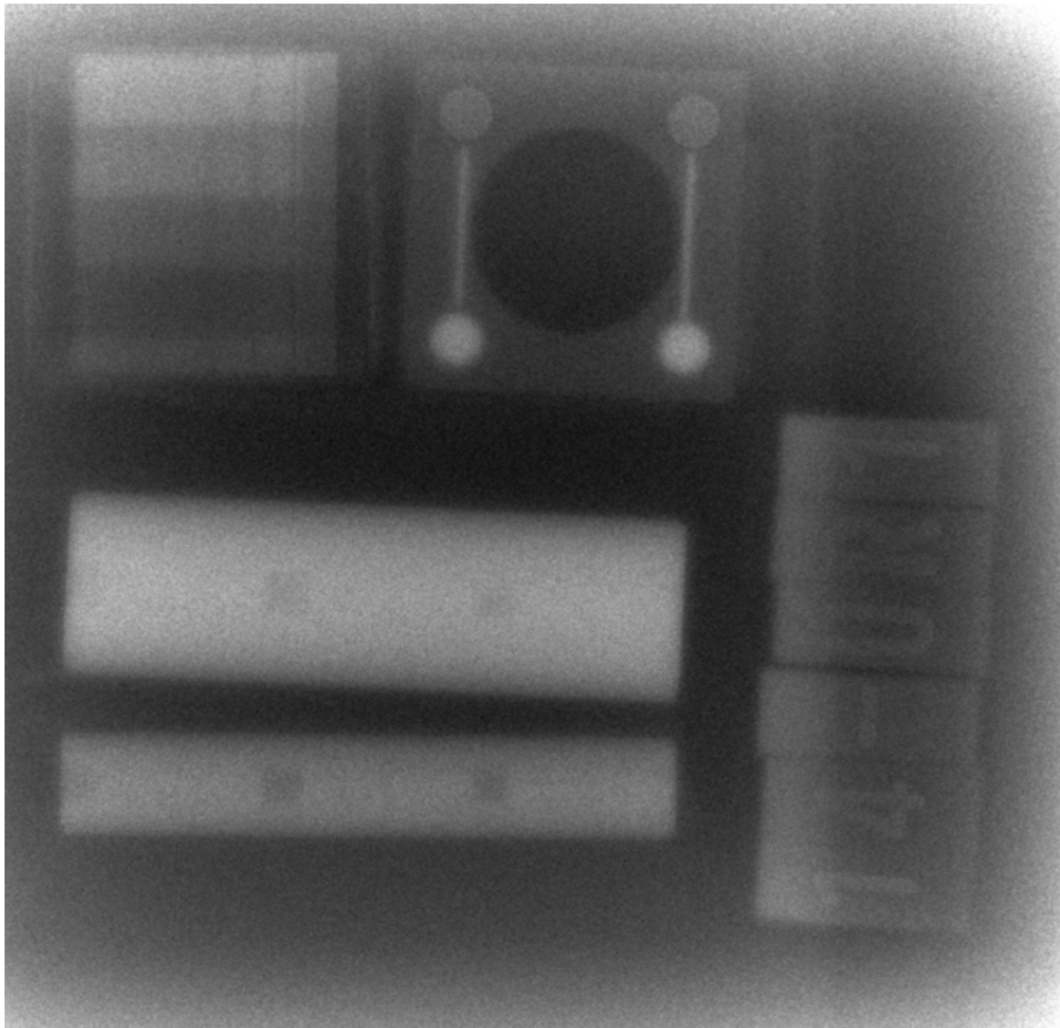
(h)BPI、Sl、ダミー火工品パイプ 8mmとパイプ 14mm BL10 300kW 運転、L/D600、90s 照射、UR-1 + Gd コンバータ
