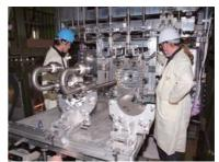
第1電磁ホーン予備機への標的予備機の着脱作業(ニュートリノ実験施設)
