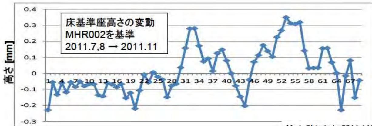
← 電磁石の水準測量データ
