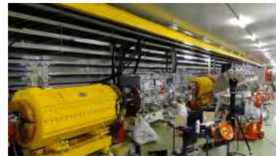
↑ 新入射キッカー電磁石の据え付け作業
