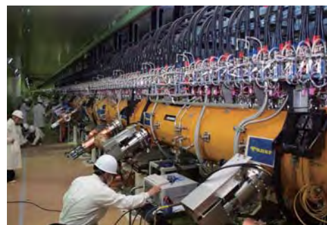
ドリフトチューブリニアックの調整作業
