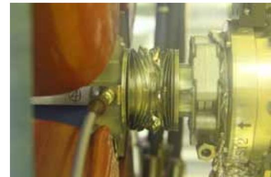
リニアックのジョイント部にあるCeramic Vacuum Current Transformer (上と右上)。損傷が見られる変形したベロー (右)。
