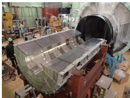
KL(中性K中間子)ビームラインに設置の装置(前置バレル部)改造作業
