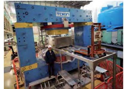
FMサイクロトロン電磁石磁性体コアの熱処理用オーブンを設置
