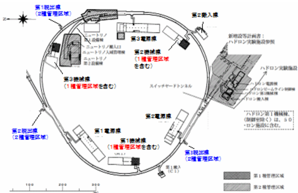
図6-8：50 GeVシンクロトロン施設の管理区域（地上部）。
