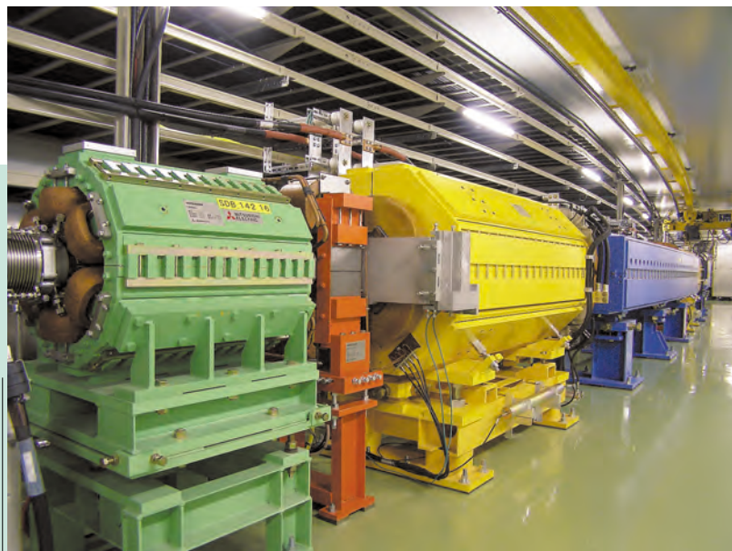
50GeVシンクロトロン(円形加速器) 1周約1600m 直径がおおよそ500mの我が国最大の陽子加速器
