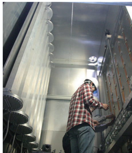
⑥ ミューオンモニタ ミューオンモニタは、ニュートリノとともに生成されたミュー粒子を測定することにより、間接的にニュートリノビームの方向およびその安定性を監視するための測定器です。
