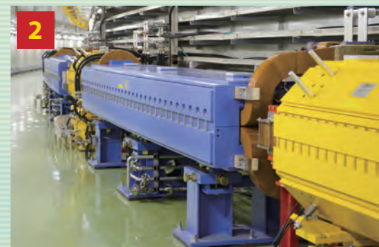
曲線部に並び電磁石群：電荷を帯びた粒子が磁場中で曲がる性質を利用し、偏向電磁石96台、四極電磁石216台を用いて陽子ビームを正確な軌道で安定に周回させます。
