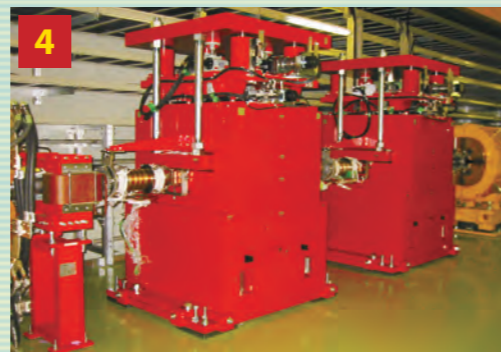
ビームコリメータ：ビームの周辺に分布している、密度の低い粒子の雲(ビームハロー)を削り取ります。ビームハローはビームロスが発生させ、加速器本体を放射化する原因となるため、決められた場所を取り除く必要があります。
