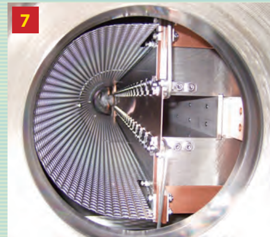
遅い取り出しセプトム磁石内部：セプトム(隔壁)構造を持つ電磁石で厚さ1.5mmの銅板隔壁に3000Aの電流を流し、隔壁の右側に発生する磁場によって、飛び込んできた陽子ビームを蹴り出します。
