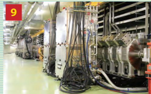
高周波加速装置群：大強度陽子ビームはここを約30万回通過することで運動エネルギー 30 GeVを獲得します。写真は世界最大級の数の陽子を加速できる、世界最高の加速勾配を持つ新型空洞と高周波増幅器です。
