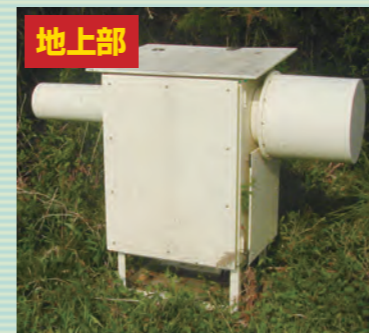
放射線モニタ：加速器の制御のために運転中に発生する放射線を測定するモニタです。MRでは地上に4カ所設置しています。
