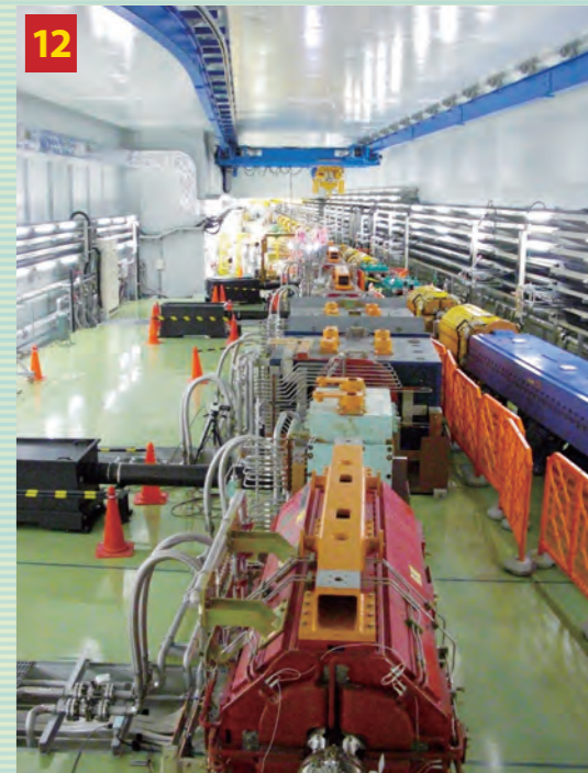
ハドロンビームライン：MRから取り出されたビームは写真中央のビームラインを通してハドロン実験ホールに輸送されます。
